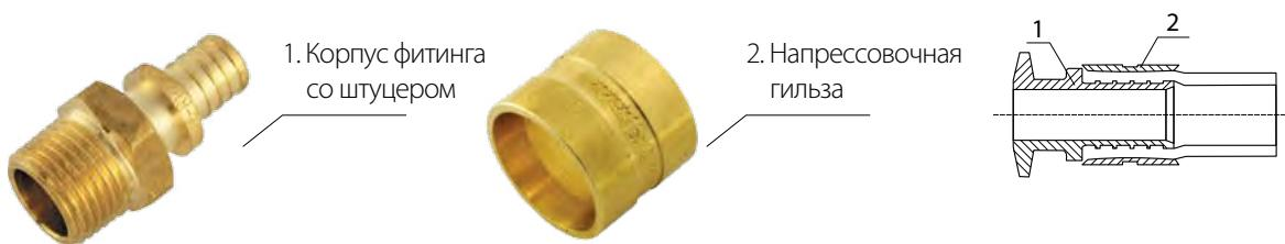
**Принцип соединения:** расширенный специальным инструментом конец трубы надевают на штуцер, после чего, благодаря молекулярной памяти, происходит усадка трубы, а для гарантированно надежного соединения на трубу надвигают напрессовочную гильзу, которая обеспечивает плотное прижатие трубы к штуцеру фитинга.
