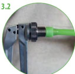
Медленно и равномерно полностью сведите рукоятки инструмента, зафиксировав их в этом положении на 3-5 секунд. Затем снова полностью разведите в стороны рукоятки инструмента и повернув его по кругу на 10-45°, введите глубже в расширенное отверстие трубы и вновь сведите рукоятки инструмента. Повторите несколько циклов расширения, погружая каждый раз сегменты головки как можно дальше вглубь трубы.
