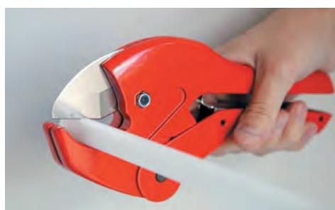
Отрезать секатором участок трубы требуемой длины.
