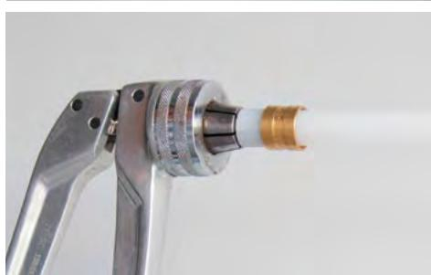
Надеть напрессовочную гильзу на трубу. Она не должна попадать в зону расширения трубы.
