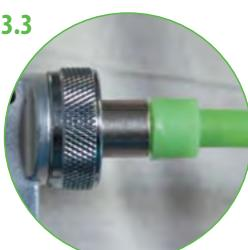
Циклы расширения трубы необходимо проводить до тех пор, пока труба не упрется в ограничительный выступ на расширительной головке инструмента. Проделайте еще один, последний цикл расширения, зафиксировав сведенные рукоятки в этом случае на 3-5 секунд.
