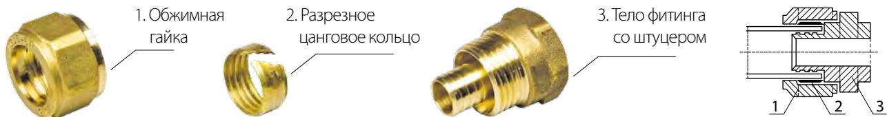
**Принцип соединения:** при закручивании гайки происходит сжатие разрезного кольца благодаря коническим фаскам с двух его сторон, а также внутри тела гайки и на теле фитинга. Кольцевые насечки на внутренней поверхности разрезного кольца производят фиксацию трубы и ее уплотнение на штуцере, который также имеет кольцевые насечки.
