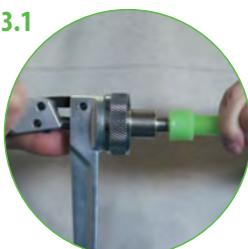
Установите на инструмент расширительную головку, **соответствующую диаметру трубы**. Полностью разведите в стороны рукоятки инструмента и вставьте сегменты расширительной головки как можно дальше вглубь трубы.
