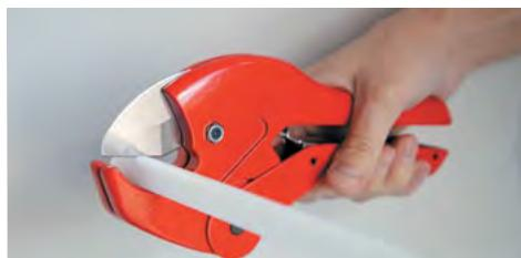
Отрезать секатором участок трубы требуемой длины.
